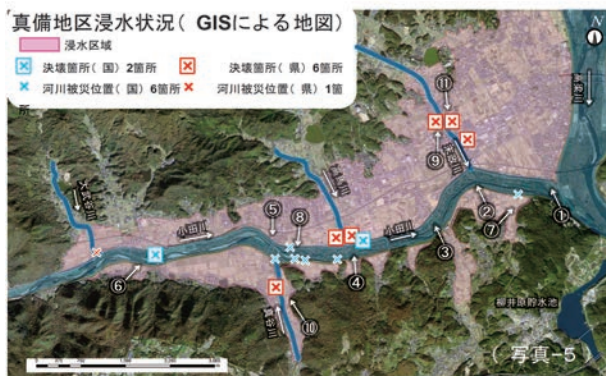
国管理河川の小田川をはじめ、県管理3河川において8か所で決壊・7か所で一部損壊・損傷し、約1,200ヘクタールが完全に水没
