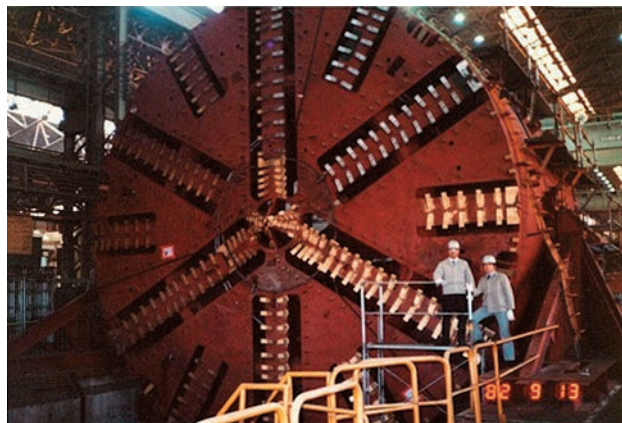
写真-4.6 完成寸前の下水道用大断面シールド機
