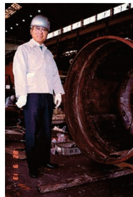
写真-4.5 製作中の小断面シールド機
