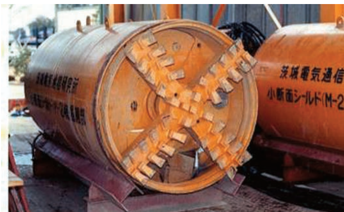
写真-4.2 立坑に設置されたシールド機掘削部
