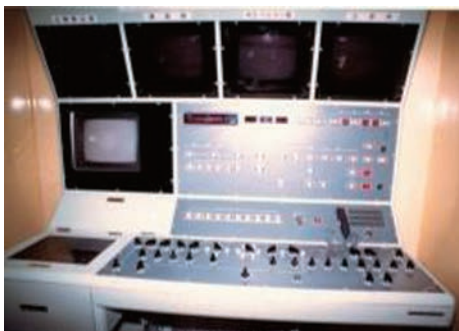
写真-4.9 遠隔操作卓 自動化し、坑内に入らず汚れない作業となるため「タキシード工法」と名称変更しようかと、冗談を言い合う。
