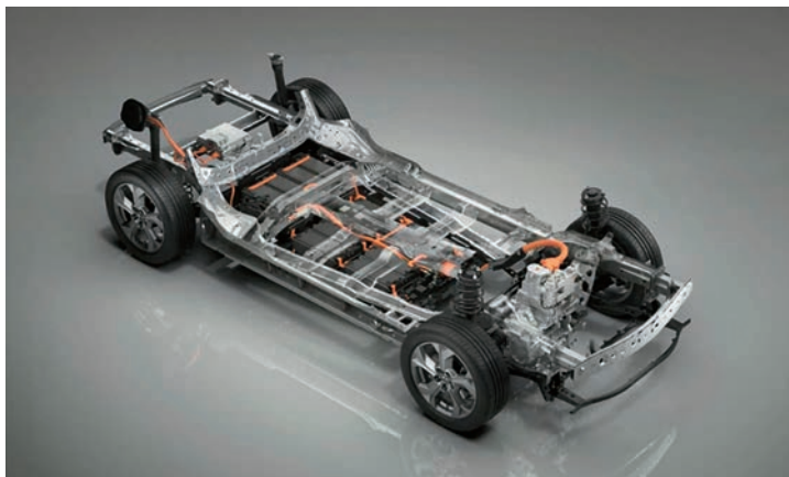
血管や神経のように車体をめぐるワイヤーハーネス ※オレンジ色の線が高電圧ワイヤーハーネス
